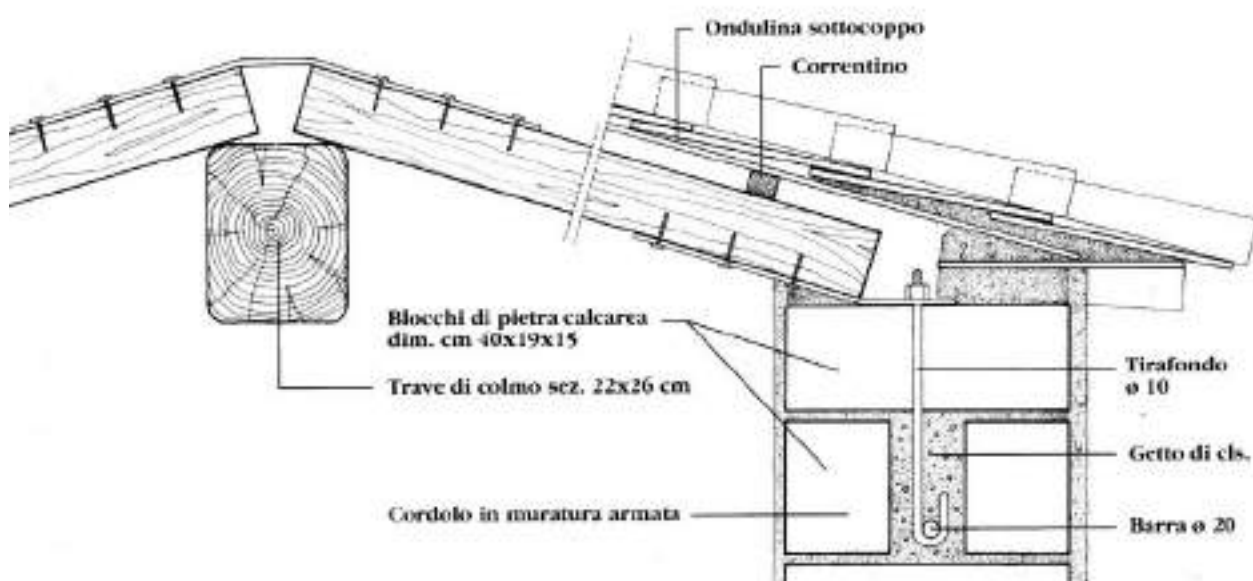
Cordolatura in muratura armata
